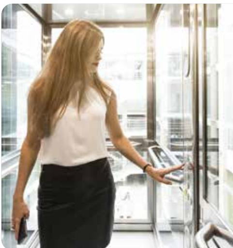
Incluso en los ascensores, los lectores de acceso **2N® Access Unit M RFID** están conectados a cuatro módulos de relé **AXIS A9188**. Estos relés se conectan a un panel en el ascensor por lo que los usuarios solo podrán acceder al piso al que tienen acceso.
